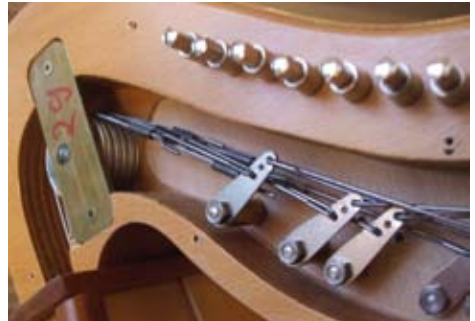
Hinter der entfernten Verkleidung am Harfenhals werden die versteckten Seilzüge sichtbar.
